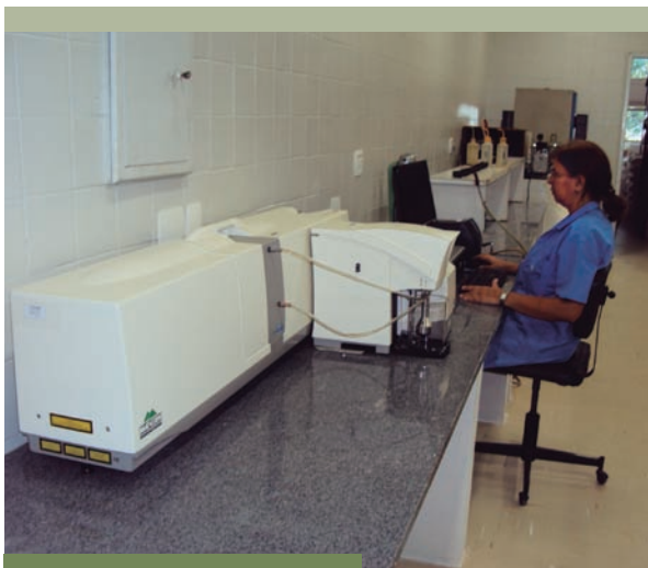
Granulômetro Mastersizer 200 instalado no Laboratório de Sedimentometria e Qualidade da Água (LSQA), instalado na SUREG-BH.
