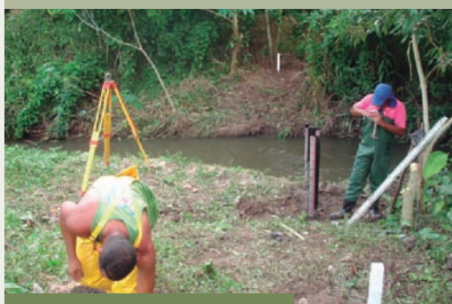
Instalação de seção de réguas e medição de vazão (Catu/BA).
