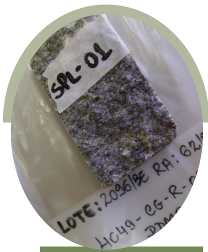
► Amostra de ortognaisse da área do Projeto Geologia e Recursos Minerais da Folha Serra Pelada (PA).
