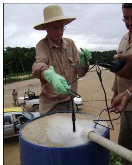
Medição de pH e condutividade elétrica em água com alto grau de contaminação por chorume, de poço de monitoramento, e coleta de amostra dessa mesma água para análises químicas.
