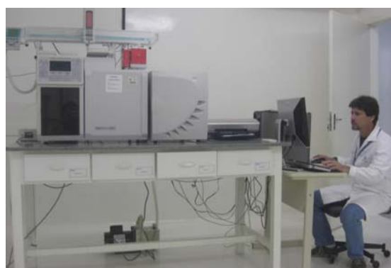
Determinação de contaminantes orgânicos voláteis e semivoláteis (pesticidas e agrotóxicos) por GC-MS-MS.
