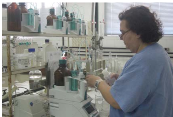
Titulador automático Titrino para determinação de dureza e alcalinidade.
