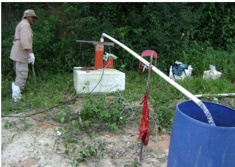
Bombeamento para coleta de amostra de água subterrânea.
